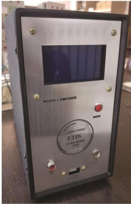
دارای حافظه داخلی جهت ثبت و ذخیره اطلاعات تمامی پارامترها در لحظات وقوع قطع و یا بروز مشکلات قابلیت ارسال اطلاعات ذخیره شده در حافظه داخلی از طریق پورت PC به USB دارای چراغ های نمایشگر وضعیت و هشدارهای صوتی عملکرد سریع، دقیق و هوشمندانه با سرعت پردازش و عملکردی در رنج میکرو ثانیه ذخیره اطلاعات در هنگام قطع برق نصب سریع و آسان دارای توجیه اقتصادی بسیار بالا، بدون نیاز به سرویس های دوره ای سیستم آنلاین پایش با تکنولوژی انحصاری و جایگزین مطمئن برای تکنولوژی سنتی چاه ارت برای تخلیه الکتریکی
